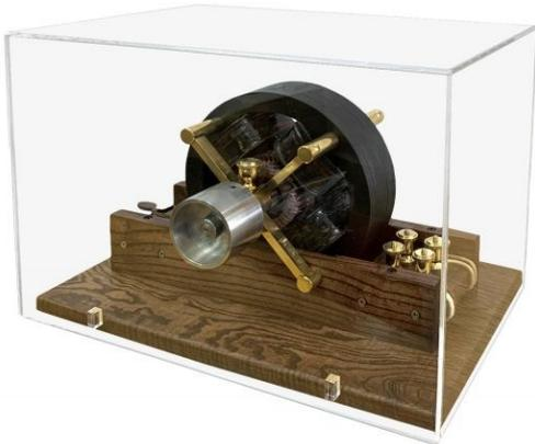
Motore a induzione con rotore
