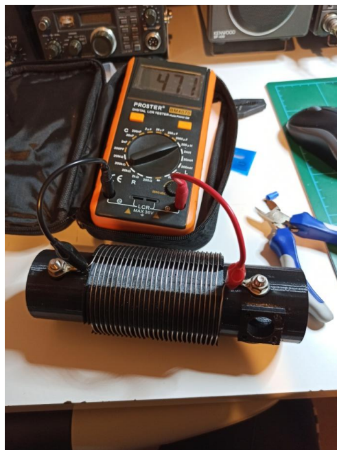
La bobina avvolta presenta una induttanza di circa 47 micro Henry
