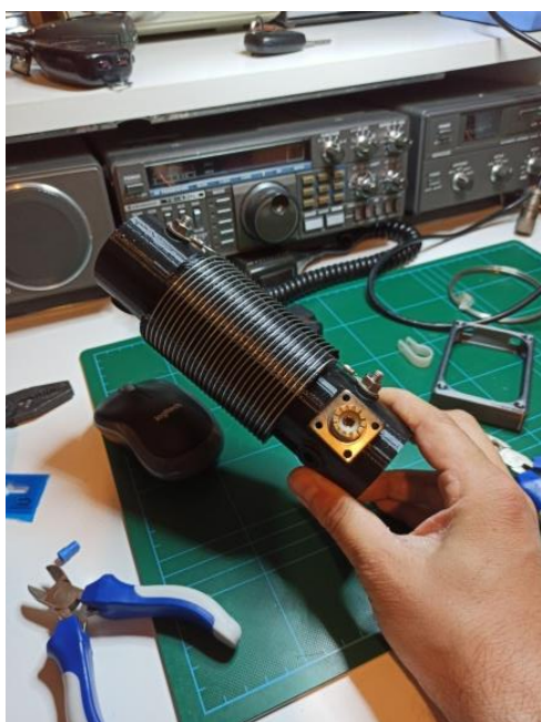
Ecco la bobina assemblata con connettore PL259 e qualche metro di rame argentato avvolto
